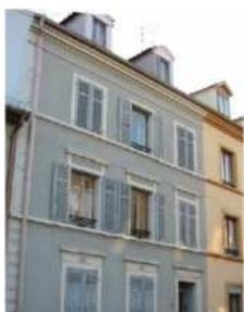
Objectif basse énergie : **Maximum 50 kWh/m<sup>2</sup>/an** d'énergie primaire pour le chauffage. La consommation initiale de ces bâtiments se situe entre 400 et 500 kWh/m<sup>2</sup>/an. Les solutions : isolation des murs, combles, rampants, planchers, fenêtres, ventilation avec récupérateur de chaleur, eau chaude solaire, chauffage collectif gaz à condensation.
