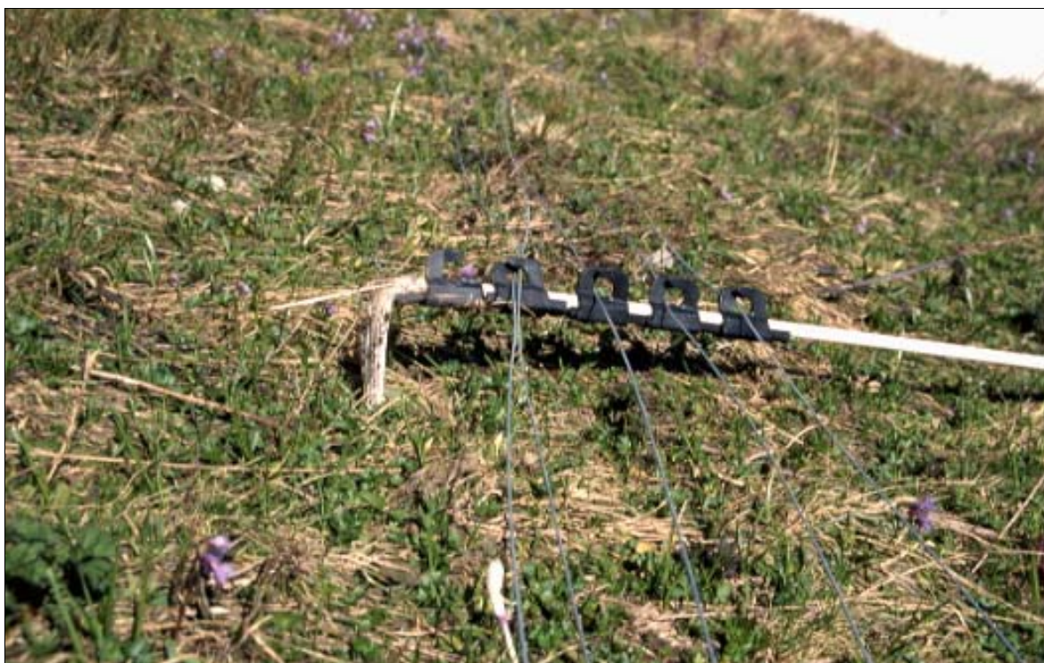
Fig. 31 : Tige en fibre de verre d'une clôture active cassée à sa base par la reptation de la neige.
